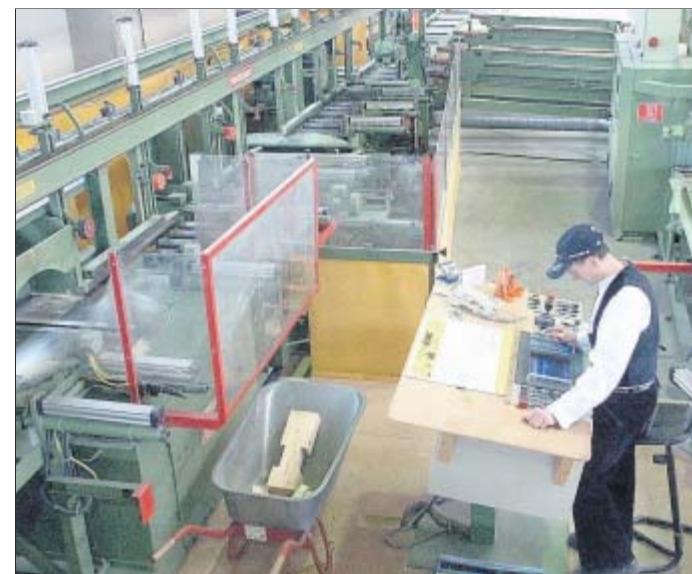
1994 wurde eine vollautomatische Abbundanlage angeschafft, die ein effizientes Arbeiten und ein millimetergenaues Zuschneiden des Konstruktionsholzes ermöglicht.
